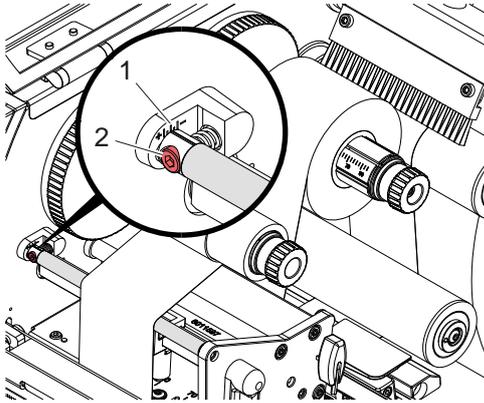
Figura 19 Regolazione scorrimento del nastro superiore
