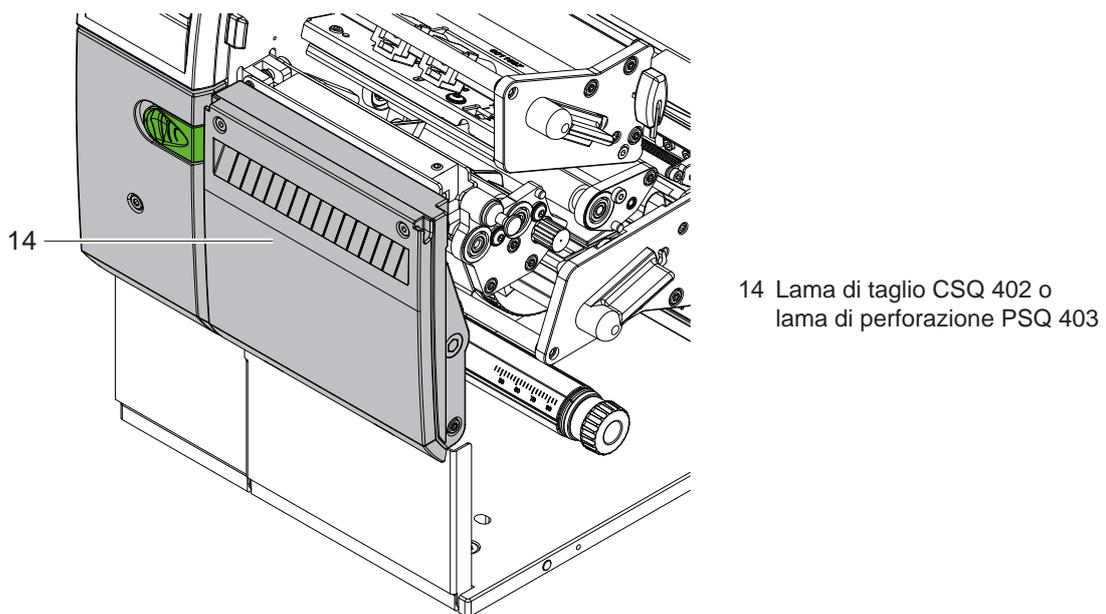
Figura 2 Versione del dispositivo con lama
