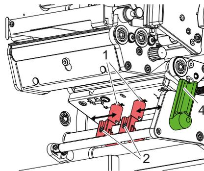
Figura 16 Regolazione sistema di pressione testina inferiore
