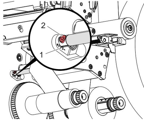
Figura 20 Regolazione scorrimento del nastro inferiore
