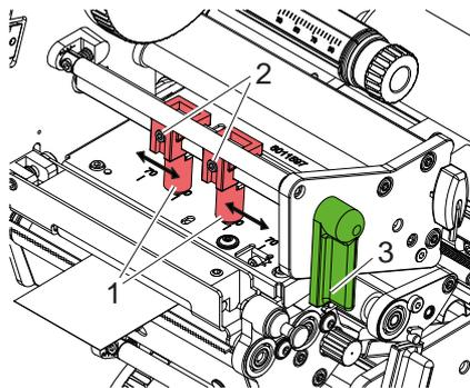
Figura 15 Regolazione sistema di pressione testina superiore
